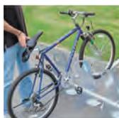
Amener l'axe de la pédale sur le point d'appui.
